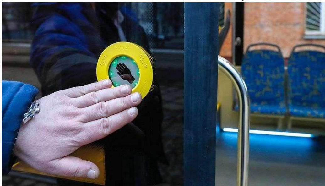
Рисунок 3. Сенсорная кнопка для адресного открытия дверей в трамvae 71-931М «Витязь М»
